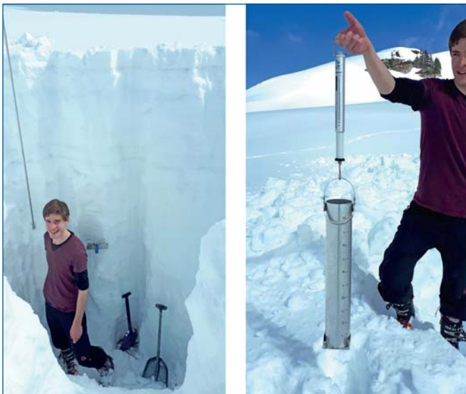
Bild 2, oben. Schneedichtemessung mit der sog. ETH-Sonde.
