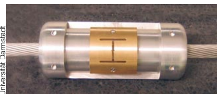
Bild 4 Der FOFW-Sensor wird direkt am Leiterseil befestigt.
